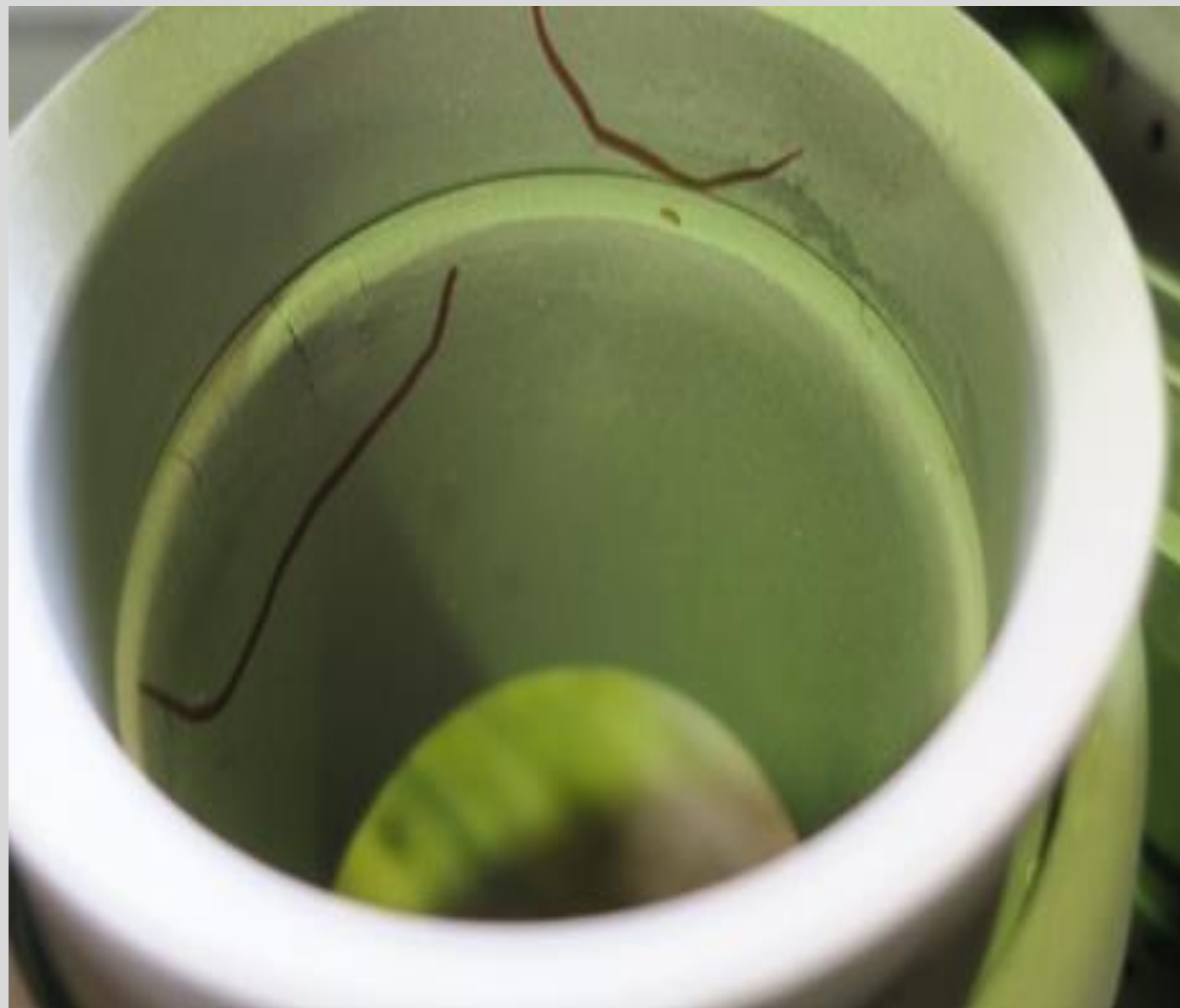
شکل ۷) ترک خوردگی کلار کپ
